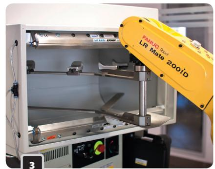
1 Die beiden Roboter fahren so von der Kartonoberkante nach innen und gleichzeitig nach unten, dass die Luft aus dem Beutel entweicht – und zwar möglichst so langsam, dass kein Material durch einen Kamineffekt nach oben aus dem Beutel entweicht. Zudem sollte sich im Beutel möglichst wenig Luft befinden.
